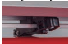
Pression des galets ajustable CE6000-120 PLUS
